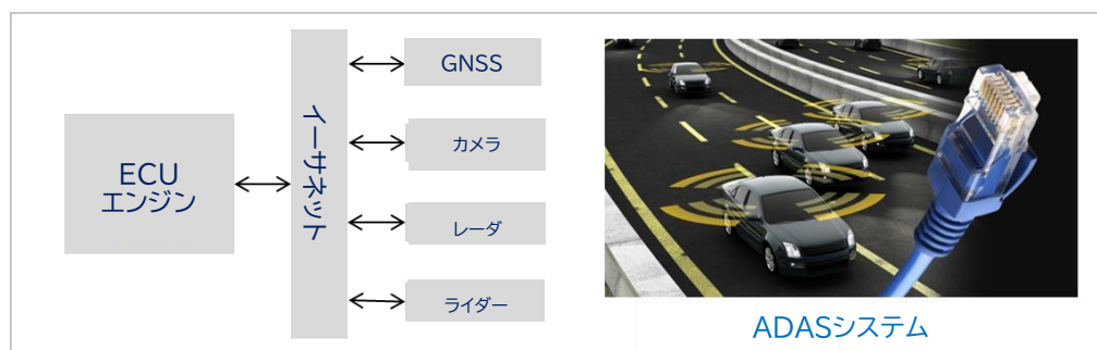
図 5: 低ジッタの MEMS 発振器は衝撃、振動、電源ノイズ、熱勾配に強く、 ADASシステムの車載イーサネットのタイミングに最適
