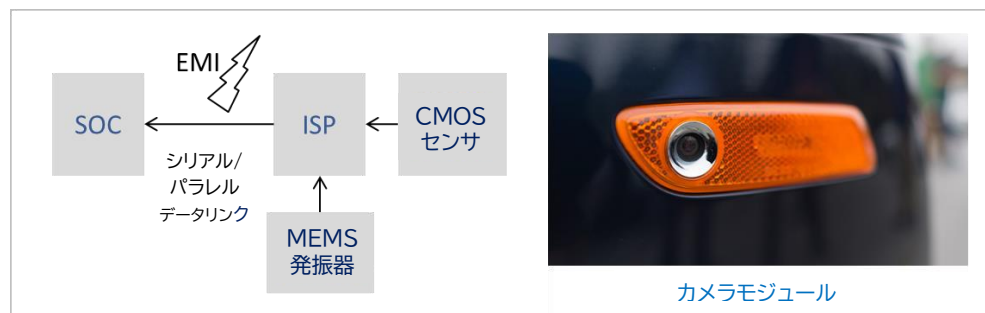
図 4: カメラモジュールなどに最適な電磁干渉低減機能を備えたMEMS発振器
