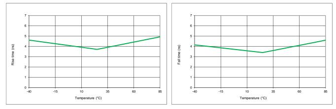
Figure 14. Rise Time vs Temperature<sup>[9]</sup>
