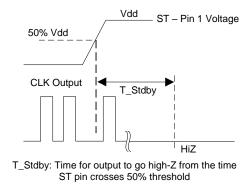
Figure 7. Standby Timing<sup>[5]</sup>
