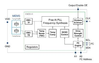
Figure 30. Block Diagram
