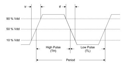
Figure 5. LVCMOS Waveform Diagram<sup>[13]</sup>
