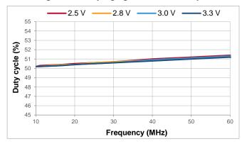
Figure 20. Duty Cycle (LVCMOS)
