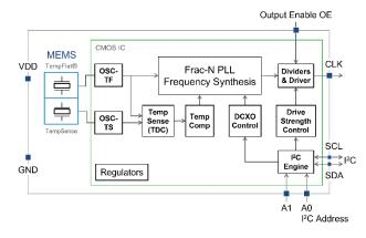
Figure 29. Block Diagram – TCXO
