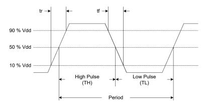
Figure 15. LVCMOS Waveform Diagram<sup>[12]</sup>
