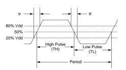
Figure 3. Waveform<sup>[9]</sup>
