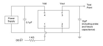
Figure 2. Test Circuit<sup>[9]</sup>
