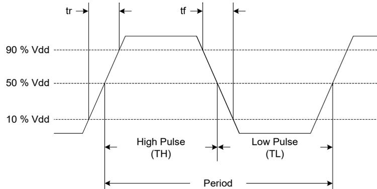
**Figure 15. LVCMOS Waveform Diagram<sup>[12]</sup>**
