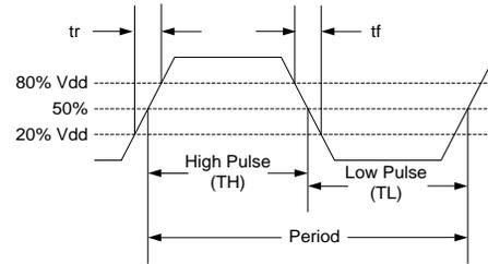
**Figure 3. Waveform<sup>[9]</sup>**
