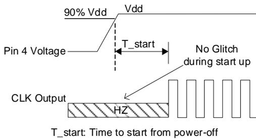
**Figure 4. Startup Timing (OE/ $\overline{ST}$  Mode)<sup>[10]</sup>**
