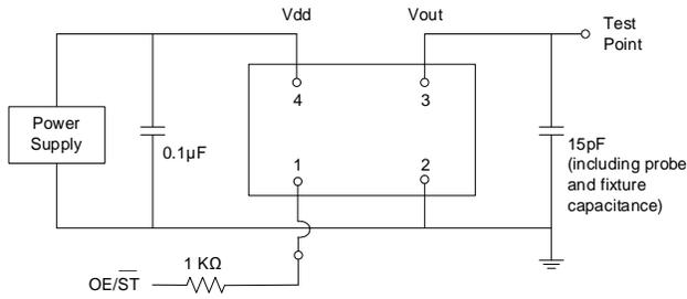
**Figure 2. Test Circuit<sup>[9]</sup>**
